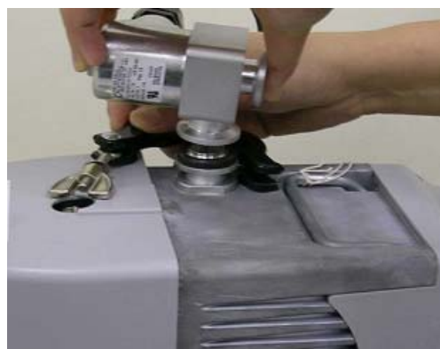
Figure 9 Vanne d'admission intégrée avec pompe IDP-3
